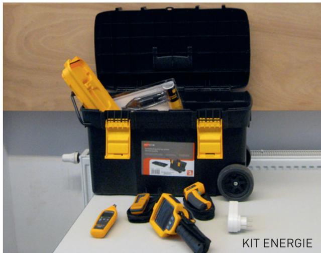
L'**hygro-thermomètre d'ambiance** mesure à la fois la *température ambiante* et le *taux d'humidité* d'une pièce.
