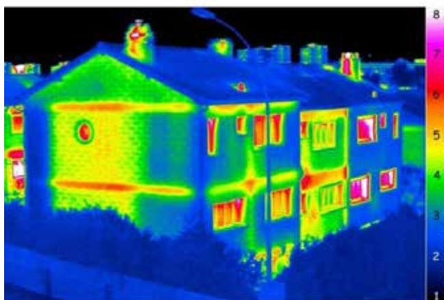
La caméra thermique permet de déceler les zones froides
